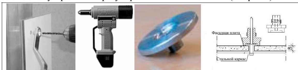
Устройство центровки отверстия в направляющей относительно отверстия в плите
